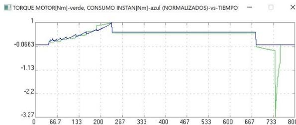
**Figura 8.** Consumo instantáneo (línea azul) y torque del motor (línea verde) normalizados contra el tiempo (seg) para la tercera parte del ciclo de manejo.
