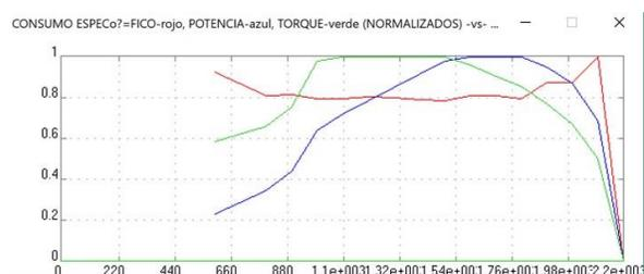
**Figura 1.** Valores máximos normalizados del par del motor (línea verde), de la potencia del motor (línea azul) y del consumo específico de combustible del motor (línea roja) contra rpm del eje del motor, tal como se obtienen de UAMmero.
