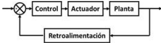
**Figura 1.** Etapas de un sistema de control de lazo cerrado.
