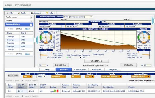
Figura 2. Simulación de los parámetros físicos del enlace de microondas.
