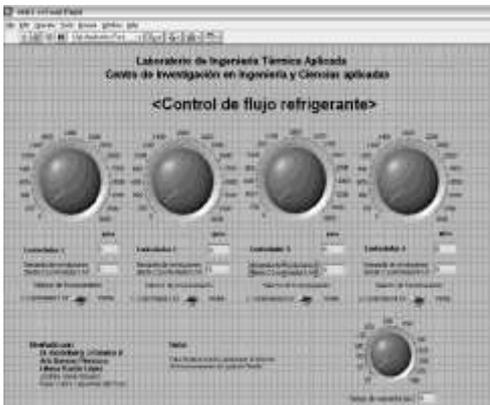
**Figura 8.** Pantalla del usuario para el control de rpm de bomba de fluido refrigerante.
