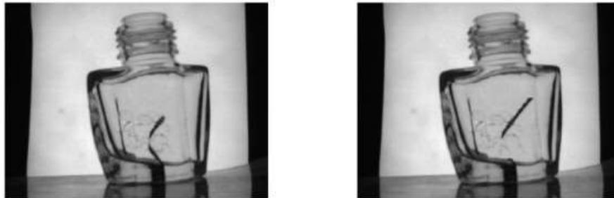
*Figura 12. Morfología Matemática (Erosión con elemento estructural tipo disco de 5X5) de imágenes con defectos.*
